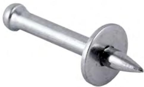
Гвозди F-NK52 обеспечивают надежное крепление благодаря стальной шайбе диаметром 12 мм, которая равномерно распределяет нагрузку и предотвращает повреждение фиксируемого материала.
