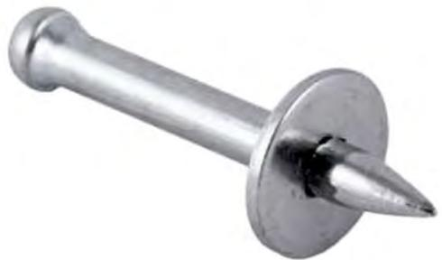
Гвозди F-NK47 обеспечивают надежное крепление благодаря стальной шайбе диаметром 12 мм, которая равномерно распределяет нагрузку и предотвращает повреждение фиксируемого материала.
