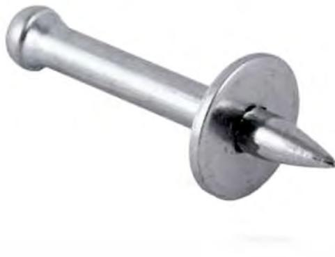
Гвозди F-NK19 обеспечивают надежное крепление благодаря стальной шайбе диаметром 12 мм, которая равномерно распределяет нагрузку и предотвращает повреждение фиксируемого материала.
